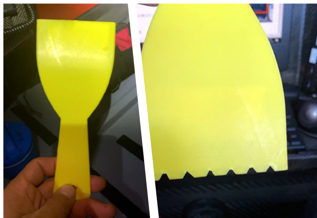
接着剤を広範囲で均一に塗りやすいように、備品のヘラをくし目に改造してメインセイルを修繕。
