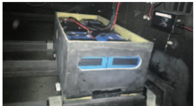
バッテリーは、予選レース「Vendée-Arctique-Les Sables d'Olonne」で高温となり不具合を起こしたリチウムイオンバッテリーではなく、使い慣れた従来のバッテリーに変更。
