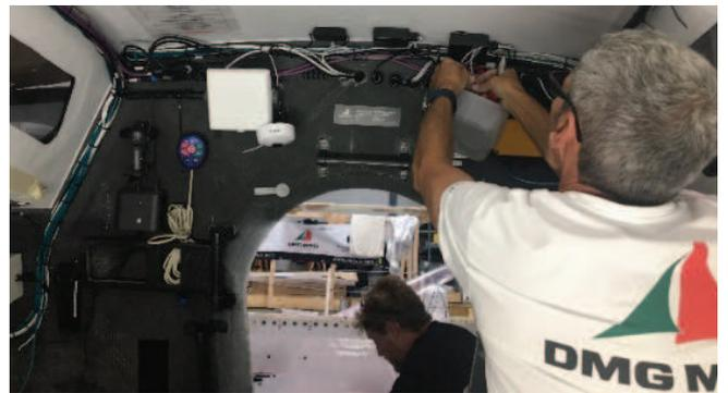
各種情報の表示を行うナビゲーションディスプレイの設置と配線作業。
