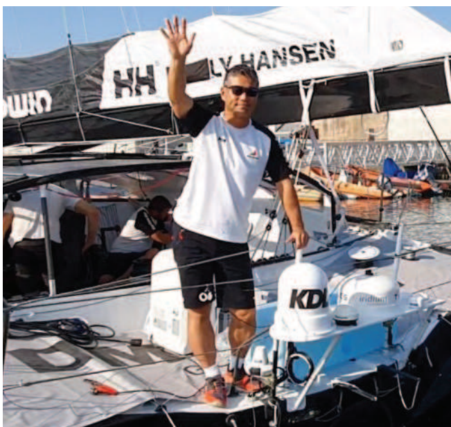
「Vendée Globe 2020」用に2つの通信システムを搭載。右がイリジウムで左がインマルサット。
