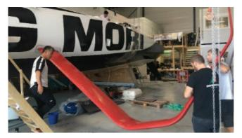
フォイルを取り付けた船体の重量は4.13トン。これに重さ4トンのキールを設置。
