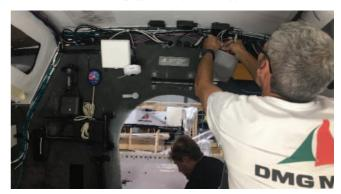
各種情報の表示を行うナビゲーションディスプレイの設置と配線作業。
