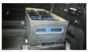
バッテリーは、予選レース「Vendée-Arctique-Les Sables d'Olonne」で高温となり 不具合を起こしたリチウムイオンバッテリーではなく、使い慣れた従来のバッテリー に変更。
